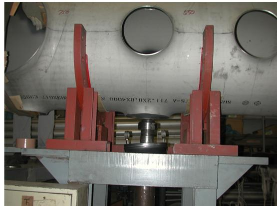
図2 引っ張り成形の様子。中央に見える“お椀状の型”を本体内部から引き抜く。写真は引き抜いた直後の状態。
