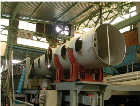
図1 枝管接合部分を引っ張り成形した真空容器母管。
