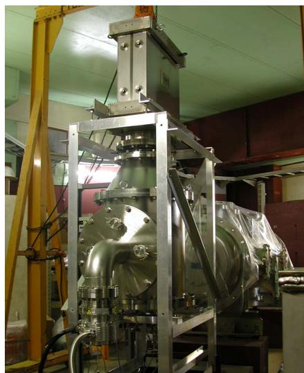
図5 サイドチェンバーを利用した高電圧発生装置の試験。後方でビニルシートに覆われているのは3m長のセパレータ本体
