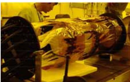
図4:SciFi 測定器プロトタイプ
