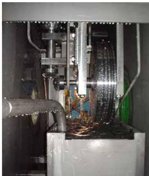
ハドロン実験施設ビームラインで最も重要な機器の一つは、二次ビーム生成標的である。一次ビーム A-ラインに T1 標的を設け幾本かの二次ラインを設置する。T1 標的は5枚の Ni 円板を、間隙をもって重ね合わせた回転標的で、冷却水で浸漬冷却される。ビームによる発熱と高い放射線場の環境で働かせる機器で、しかも機械的な構造、回転機構、冷却方式等に様々な新しい方式を取り入れなければならない。これまで慎重に設計・検討と R&D とを進めてきた。2003 年度試験的に製作し、東カウンターホールのビームラインモックアップでテストしたプロトタイプに続き、2004 年度は実機につながる実証モデルを製作した。3月に製作会社の工場で、全体が組み上がり、立ち会い試験を行った。回転駆動性能、上下駆動機構、冷却水循環系、組み込み遮蔽体の着脱等、十分良好な性能が確認され、KEK に納入された。2005 年度モックアップで各種の試験、データ測定等を行い、最終的な実機の完成に向かう。
