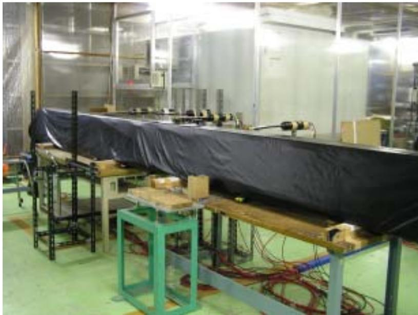
図 3.2: 宇宙線テストにおけるセットアップ図
