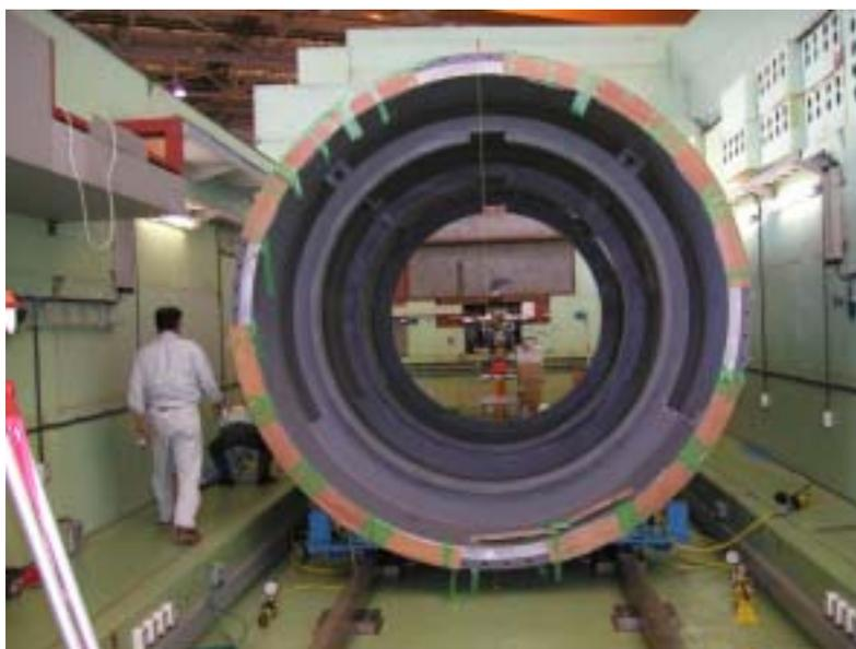
図 2.20: MB モジュールを挿入する真空容器 (K0 エリアにて)。この容器の重量は約 20 トンである。
