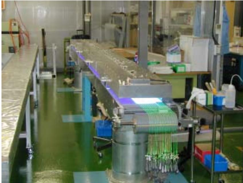
図 2.12: Plastic Scintillator とファイバーの接着
