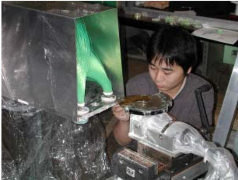
図 2.18: ファイバー端部の研磨
