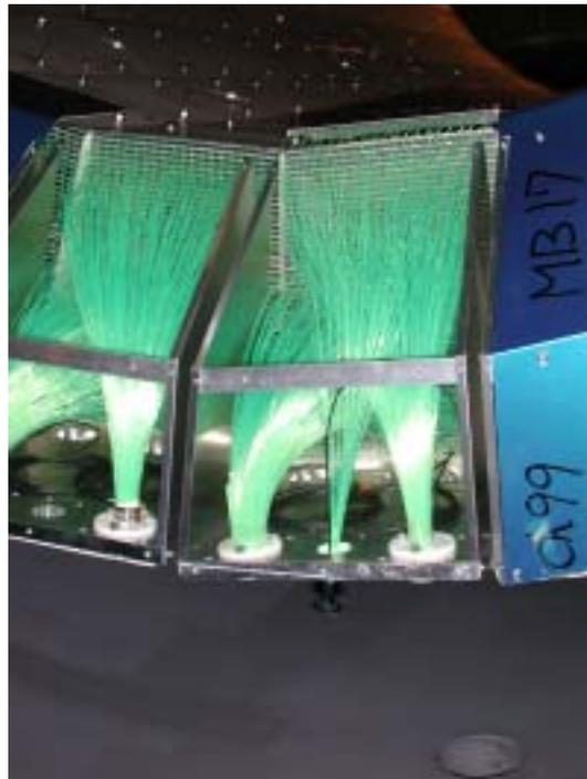
図 2.17: ファイバーの端末処理。内側の 15 層分のファイバーと外側 30 層分のファイバーを 2 つに分け処理した。まとまったファイバーの直径は内側が約 20mm $\phi$  で外側が約 30mm $\phi$  である。
